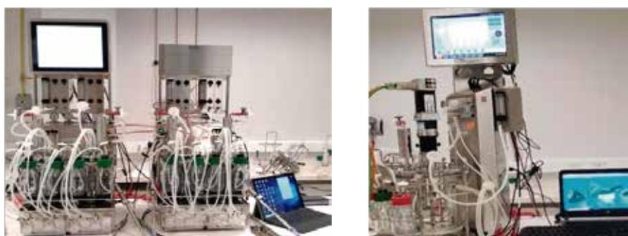
Figura 27: Biorreatores do ISI Biomassa. Biorreator de 0,5 L (a) biorreator 3,5 L (b)
