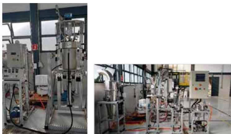
Figura 30: Reatores de alta pressão.
