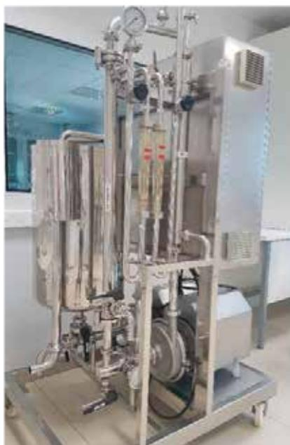
Figura 31: Biorreator de 120L
