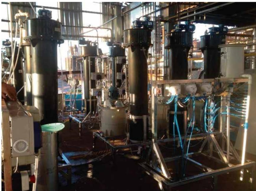
Figura 36: Planta de extração seletiva para extração de cloretos e fluoretos
